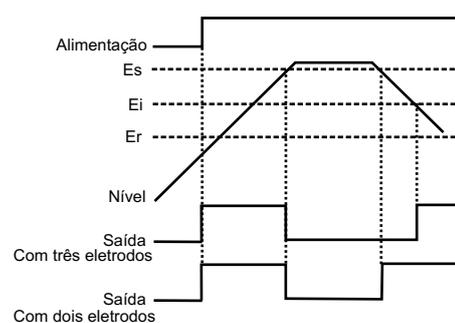
O modelo **RNS-3IE/22-** funciona igual o modelo RNS-3I/22- e o modelo **RNS-3SE/22-** funciona igual o modelo RNS-3S/22- Porém estes dois modelos **RNS-3IE/22-** e **RNS-3SE/22-** possuem um ajuste de sensibilidade maior, para líquidos menos condutivos, exemplo água mineral.
